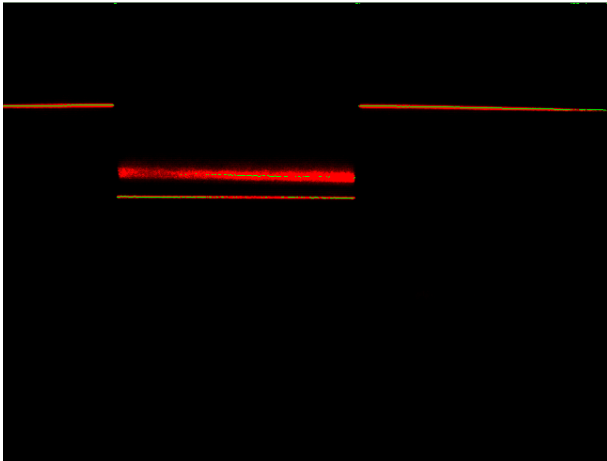
Переотражения лазерного луча на объекте сложного профиля
