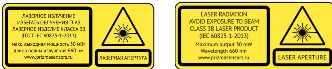
Рисунок 1.4 – Пример маркировки на корпусе сканера для класса опасности 3В
