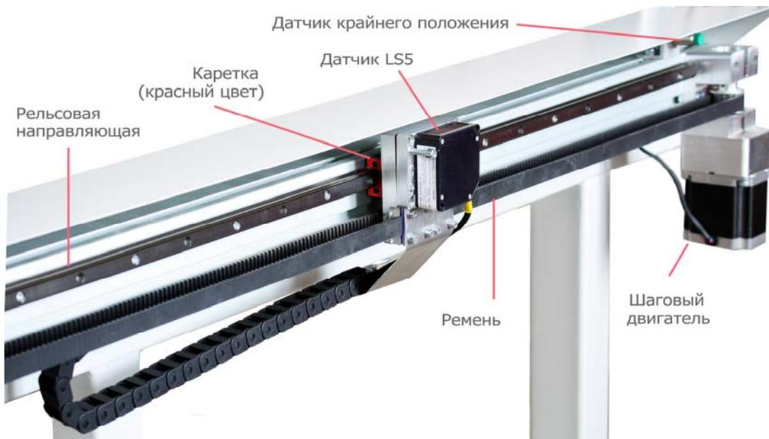
Рисунок 2 – Фрагмент нижней секции установки (без кожуха)
