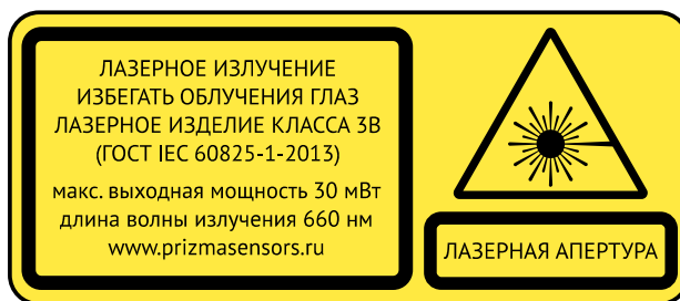
Рисунок 2.1 – Пример маркировки на корпусе сканера класса опасности 3В
