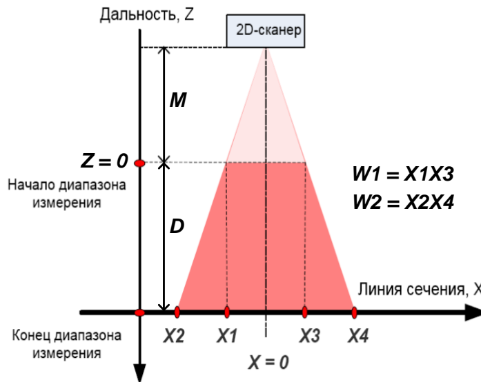
Рисунок 9.1 – Область видимости сканера
