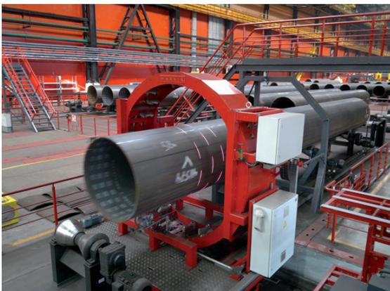
3D лазерная измерительная машина специально разработана для контроля геометрических параметров труб большого диаметра. Машина состоит из 24 широкодиапазонных высокоскоростных синхронизированных лазерных сканеров типа RF625-650, размещаемых вокруг трубы, что позволяет проводить инспекцию всего профиля трубы в процессе её изготовления.
