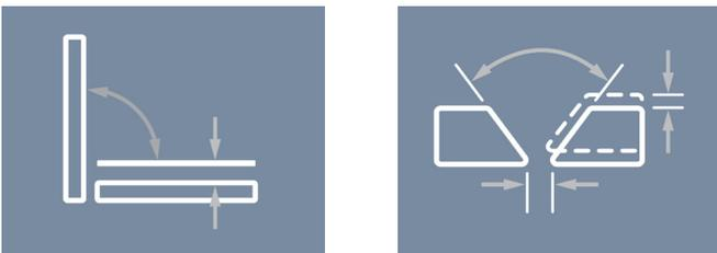
ИЗМЕРЕНИЕ ОТКЛОНЕНИЯ, УГЛА СОЕДИНЕНИЯ, ВЕЛИЧИНЫ ЗАЗОРА И Т.П.
